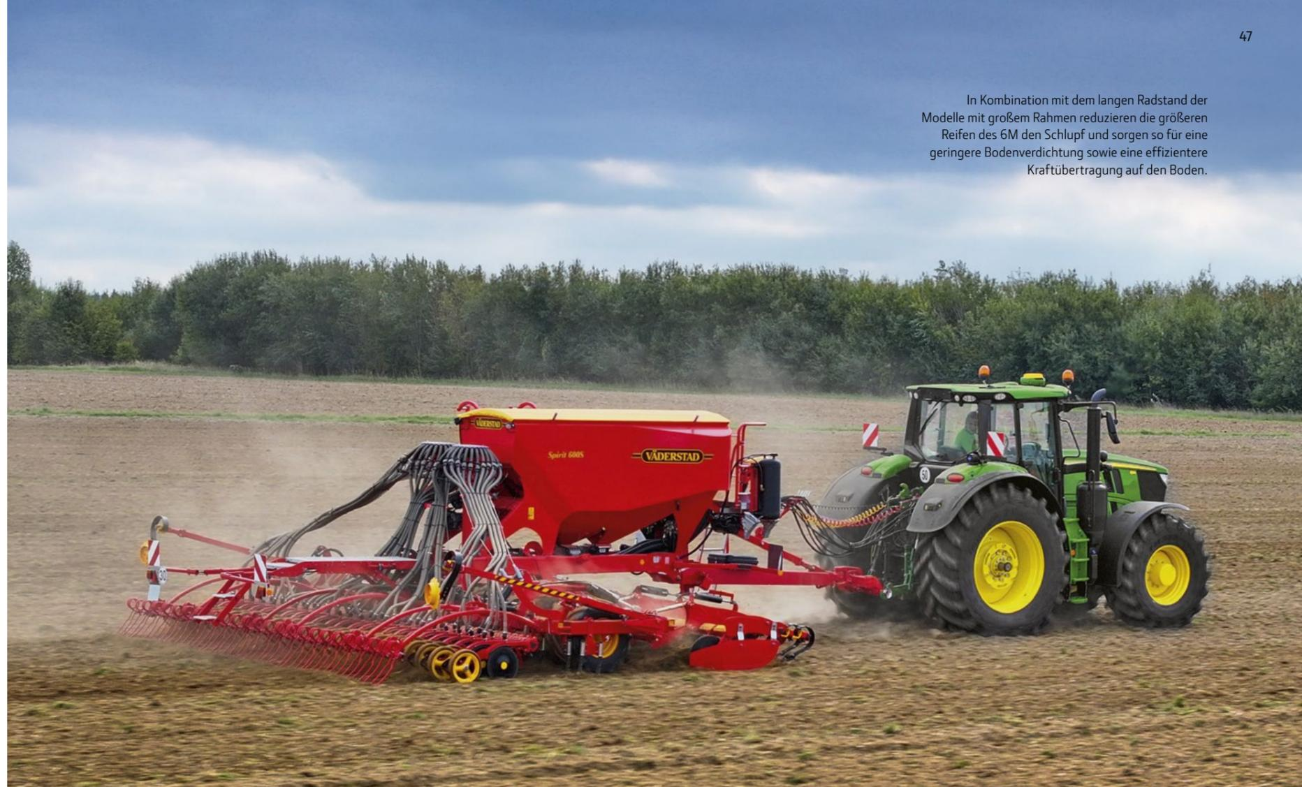
In Kombination mit dem langen Radstand der Modelle mit großem Rahmen reduzieren die größeren Reifen des 6M den Schlupf und sorgen so für eine geringere Bodenverdichtung sowie eine effizientere Kraftübertragung auf den Boden.
