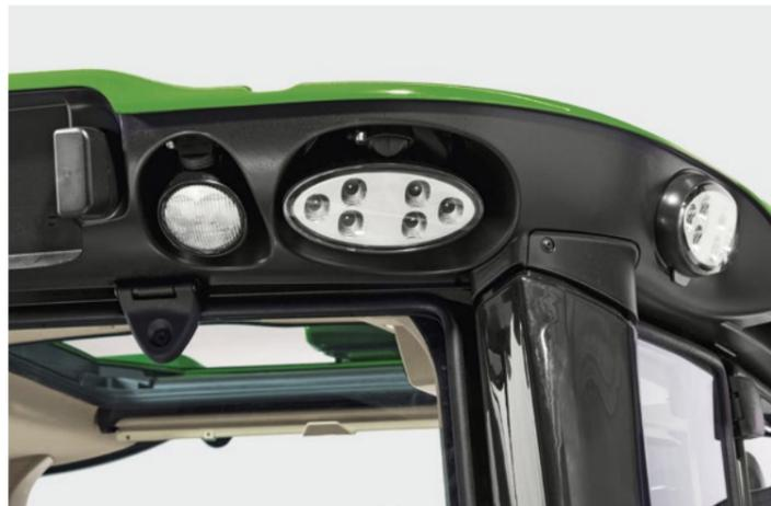
Unsere werkseitig installierten Beleuchtungspakete ermöglichen ein breites, konzentriertes Lichtfeld rund um Ihren 6M Traktor. Für anspruchsvollere Beleuchtungsanforderungen können Sie LED-Beleuchtungspakete auswählen. Diese verbrauchen weniger Strom, liefern helleres, tageslichtähnliches Licht und sind langlebiger.
