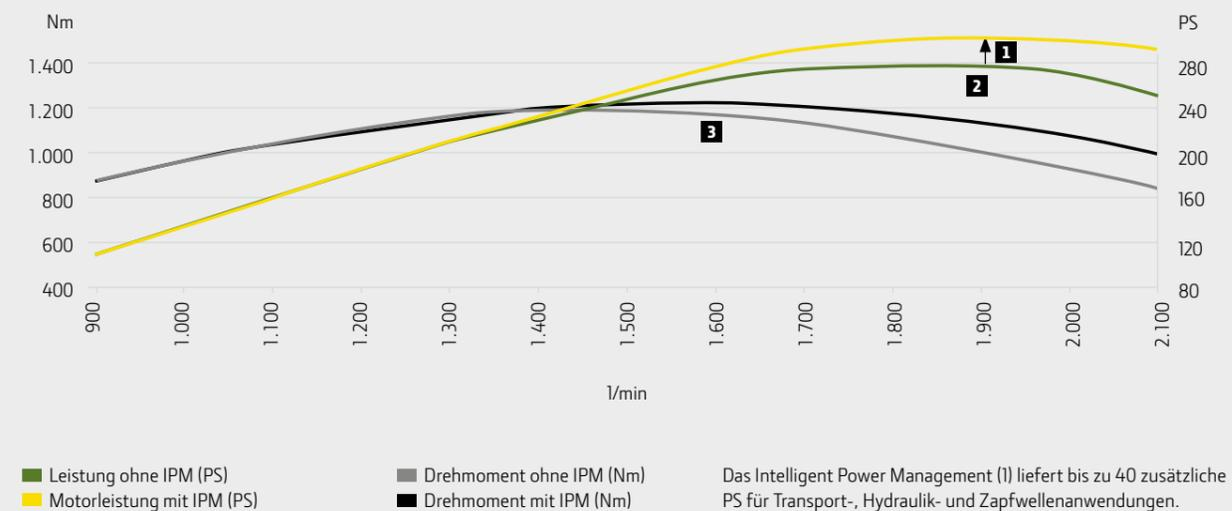
Das Intelligent Power Management (1) liefert bis zu 40 zusätzliche PS für Transport-, Hydraulik- und Zapfwellenanwendungen. Maximale Motorleistung (2) und maximales Drehmoment (3) werden bei 1.900 bzw. 1.600 1/min erreicht, um ein optimales Ansprechverhalten bei geringem Kraftstoffverbrauch zu gewährleisten.
