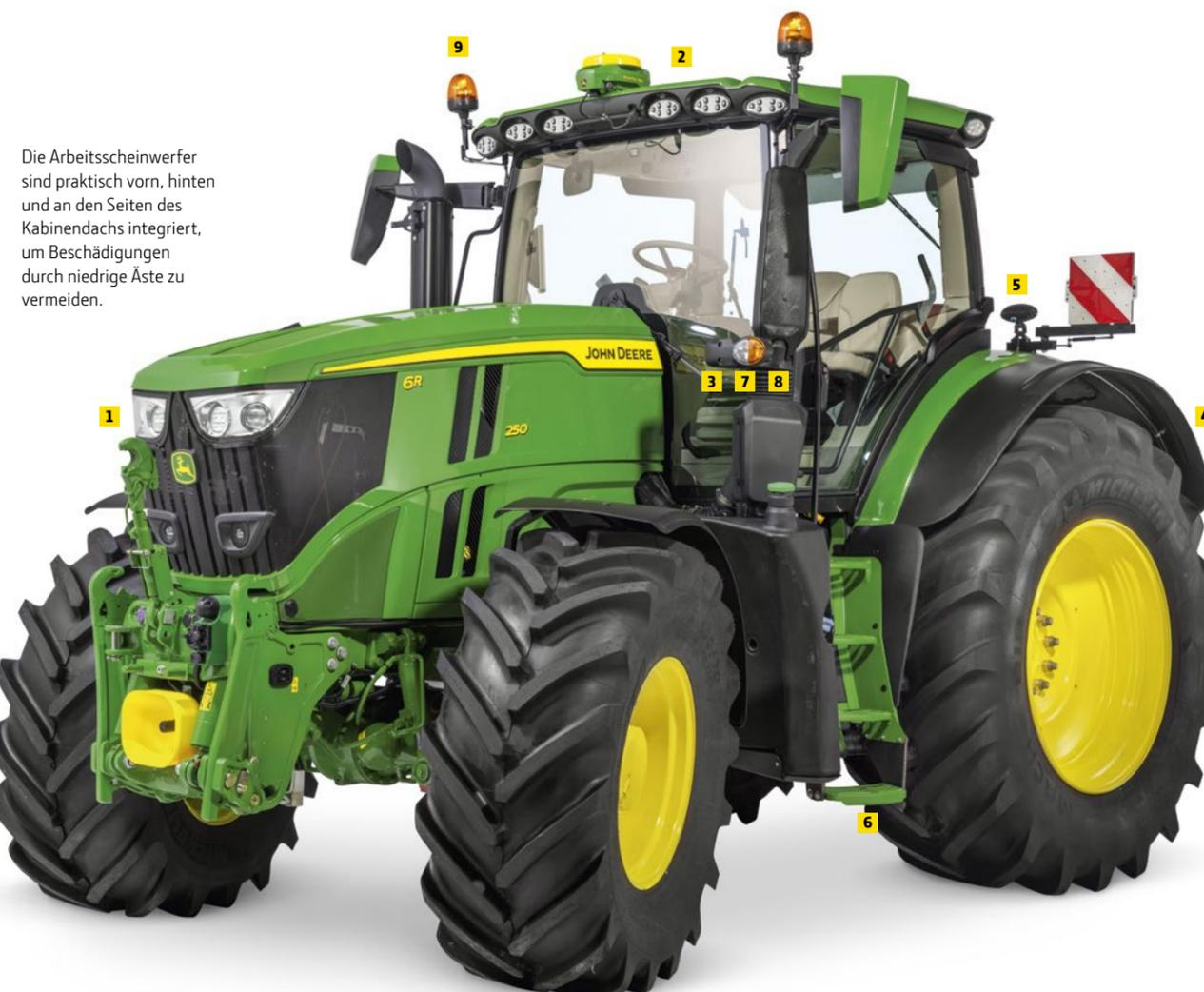
Die Arbeitsscheinwerfer sind praktisch vorn, hinten und an den Seiten des Kabinendachs integriert, um Beschädigungen durch niedrige Äste zu vermeiden.
