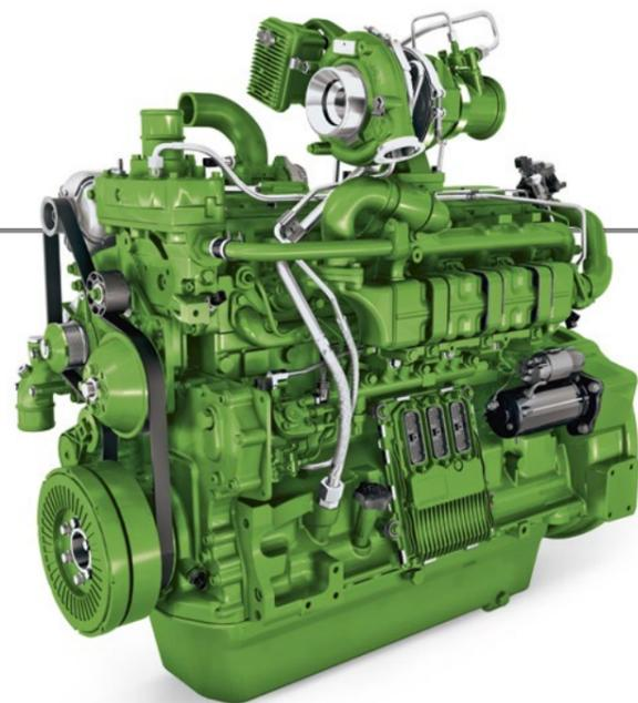
Unsere PSS-Motoren mit 4,5 l Hubraum (6R 110, 6R 120, 6R 130, 6R 140 und 6R 150) machen sich die zweistufige Abgasturboaufladung zunutze. Hierbei vervielfacht der Turbolader mit Abgas-Bypassventil den von einem zweiten Turbolader mit unveränderlicher Geometrie erzeugten Druck. Diese Reihenordnung erhöht die Leistung im 6R 150 auf bis zu 177 PS (max. mit IPM). Alle 6-Zylinder-Motoren bieten längere Ölwechselintervalle von bis zu 750 Betriebsstunden<sup>1</sup> und Hydraulik-IPM.
